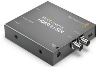
Die Patentlösung für die Umwandlung von HDMI nach SDI in allen SD- und HD-Formaten bis zu 1080p/60! Er kann Audio von HDMI-, symmetrischen Analog- oder AES/EBU-Eingaben einbetten. Der Mini Converter HDMI to SDI bietet sich an, um Computer und Kameras mit HDMI-Anschlüssen um einen SD- bzw. HD-SDI-Ausgang zu erweitern. Oder wenn kein Ultra-HD-Modell nötig ist und man sich die Kosten sparen will.
