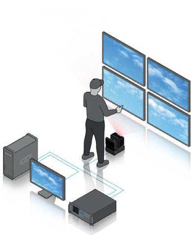
Der AirScan ist ein Laserscanner, der Entfernungen in zwei Dimensionen misst. Damit ermöglicht er die optische und kontaktlose Erkennung von Objekten, Personen bzw. der Hände von Personen. Er kann für jede berührungslose Interaktion mit einem Display oder einer projizierten Touchoberfläche verwendet werden.
