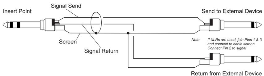
Das Send-Signal kann als alternativer Direktausgang vor dem Fader und der Entzerrung (pre-fade, pre-EQ) abgegriffen werden; dazu ist ein Kabel nötig, bei dem Spitze und Ring kurzgeschlossen sind, um den Signalfuß nicht zu unterbrechen (s.u.).
