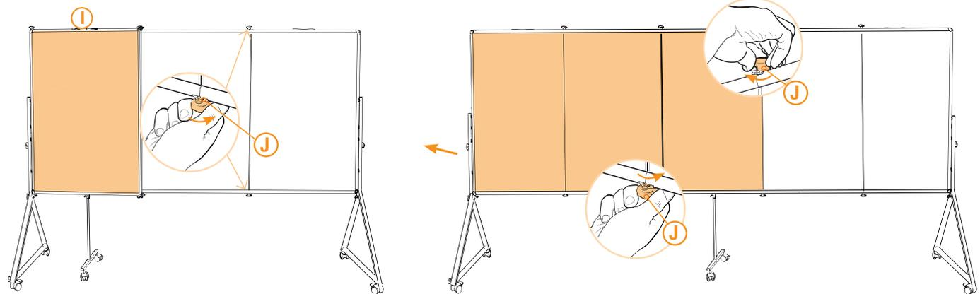
Die beiden Griffmutter **J** an den Scharnieren oben und unten anziehen.
