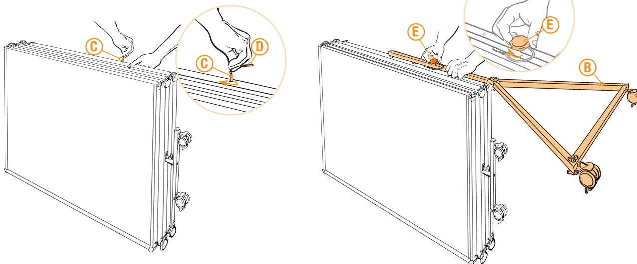
Gewindestifte **C** mit dem Innensechskantschlüssel **D** in die vorgesehene Bohrung an den Seiten der Tafel **A** bis zum Anschlag fest eindrehen.
