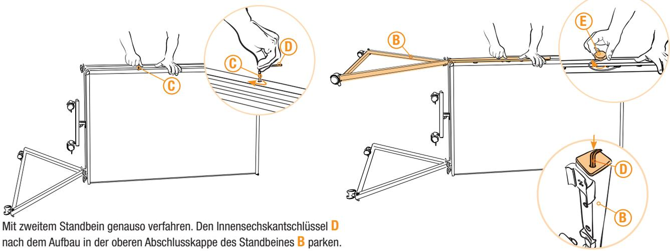
Mit zweitem Standbein genauso verfahren. Den Innensechskantschlüssel **D** nach dem Aufbau in der oberen Abschlusskappe des Standbeines **B** parken.
