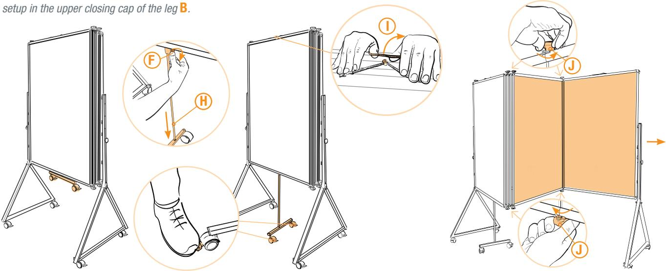
Flügelschraube **F** am Stützbein **H** lösen, Stützbein bis zum Boden ausziehen und mit der Flügelschraube fixieren. Bremsen runterdrücken. (Die GraphicWall V3 XL kann im zusammengeklappten Zustand platzsparend verstaut werden. Die Tafel bleibt dabei mobil).
